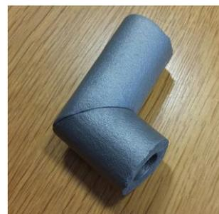
Praktische Demonstration der Isoliertechnik für Rohre, Formteile und Armaturen in der Werkstatt
